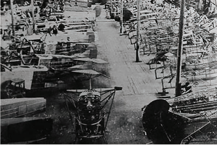
شكل ١٧-٢: حظيرة أخرى بمصانع فكر الهولندي، بها عدد عظيم من أجسام الطائرات بغير أجنحة أو محركات، ويتبين المدقق فيها أن هيكل هذه الأجسام مصنوع من أنابيب معدنية.
